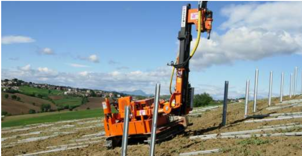
Ilustración 6: Máquina hincapostes. Fuente: Pauselli Group
