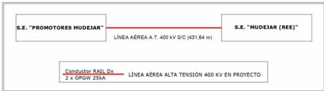
Esquema de la instalación proyectada: LAT 400kV
