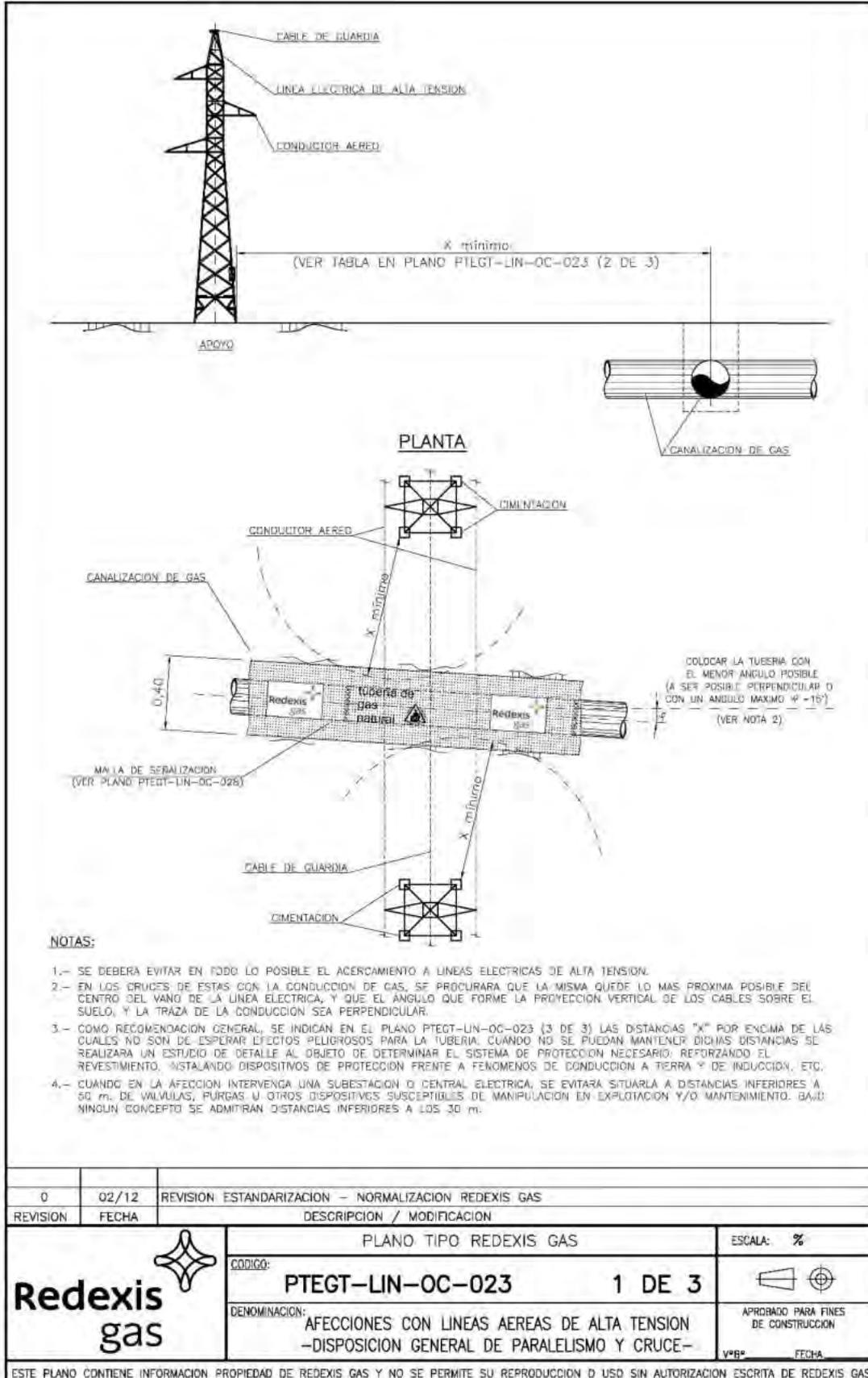
DISTANCIAS PARA LAS QUE NO EXISTE AFECCION PREVISIBLE CON UN REVESTIMIENTO NORMAL DE POLIETILENO EXTRUIDO EN FABRICA (V max = 5 kV)
