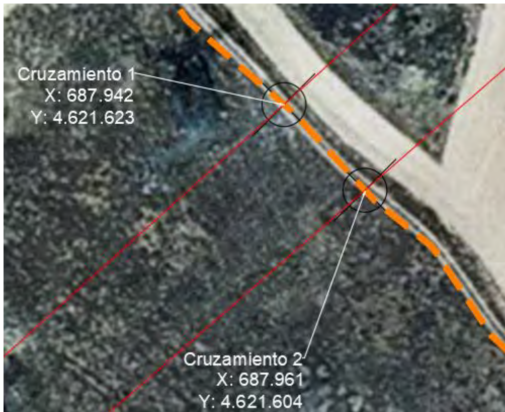
Ilustración 3: Cruzamiento zanja MT con LAATs 132 kV E-Distribución
