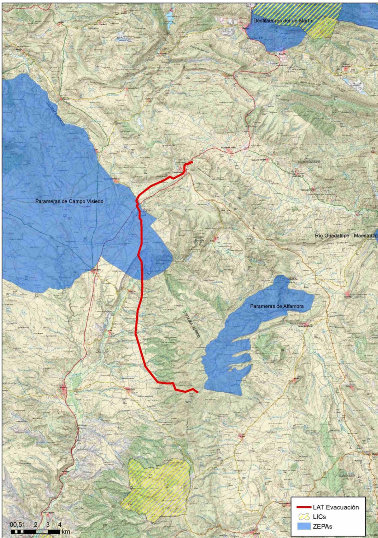
Figura 7. Áreas naturales singulares en el entorno de la línea eléctrica SET Hoyalta – SET Sierra Costera (Fuente: IGN, Gobierno de Aragón y Molinos del Ebro)
