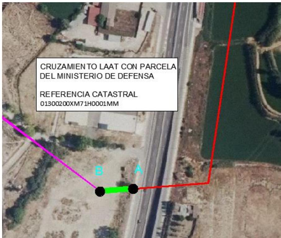
Figura 13. Detalle afección de la línea aérea
