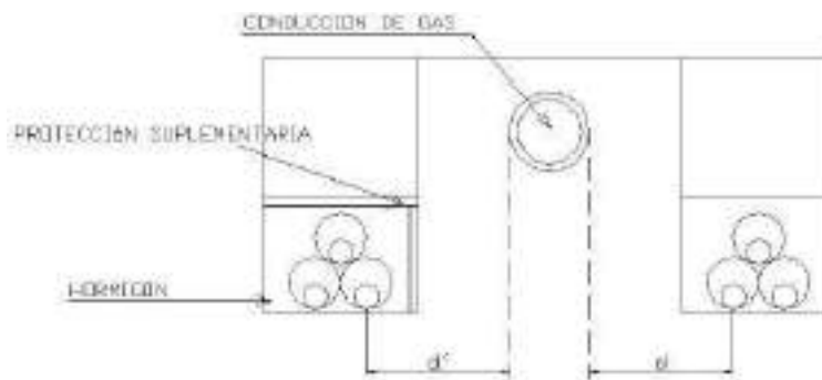
Figura 18. Canalización de cables de telecomunicación
