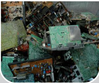
**5** En ocasiones hay que descontaminar algunas de las fracciones. Después, por diferentes mecanismos, la mayoría de sus componentes se convierten en materias primas.
