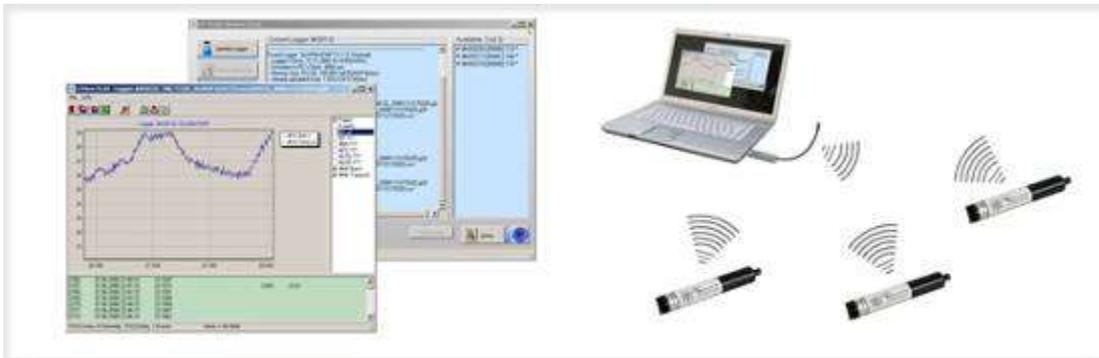
Estos termómetros automáticos tienen comunicación inalámbrica. Los datos se recogerán en el campo mediante un miniordenador provisto de una antena y un programa de descarga.
