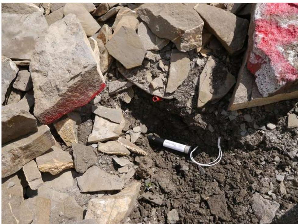
Sustitución del termómetro de la cara oeste del Tobacor.
