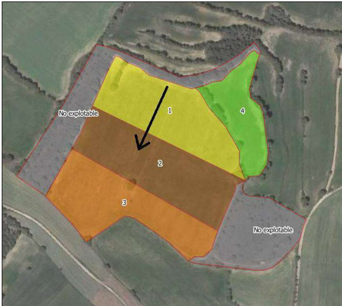
Figura 7: Croquis de la forma / avance de la explotación prevista, en amarillo se destaca la zona de cultivo la parcela de menor cota, algo "aislada" del resto que se explotará en una última fase en caso de ser necesario.
