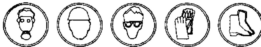
USO OBLIGATORIO DE MASCARA USO OBLIGATORIO DE CASCO PROTECCION USO OBLIGATORIO DE GAFAS USO OBLIGATORIO DE GUANTES USO OBLIGATORIO DE BOTAS DE CALCHO
