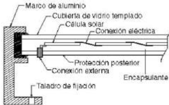
Ilustración 7. Representación del corte longitudinal de un módulo fotovoltaico (Fuente: Externa)
