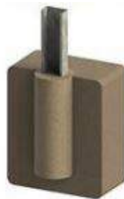
Imagen 18: Ejemplo de cimentación con perforación
