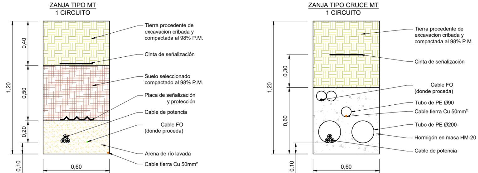
ZANJAS PARA CANALIZACIONES DE E-DISTRIBUCIÓN ENTRADA Y SALIDA A CENTRO DE SECCIONAMIENTO
