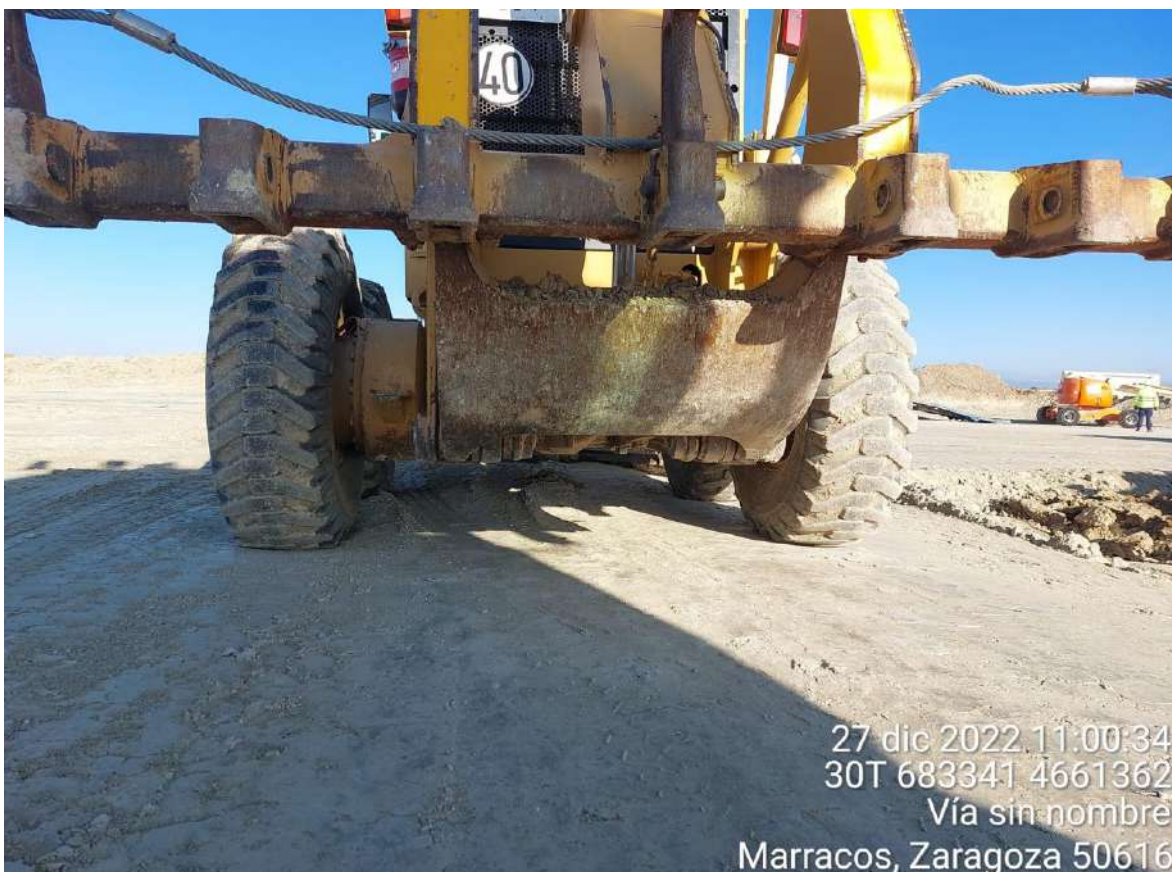
Imagen 3. Maquinaria parada en OBIII-01 y sin cubetos de contención que actúen y protejan el suelo ante posibles fugas.
