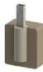
Micropilote de hormigón
