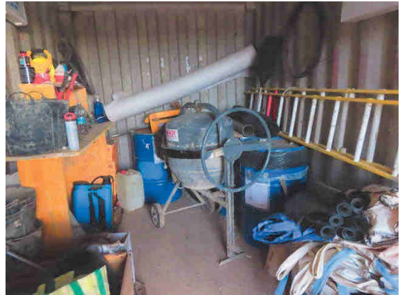
Hormigonera, escalera, etc. impidiendo el acceso a contenedores de residuos peligrosos.
