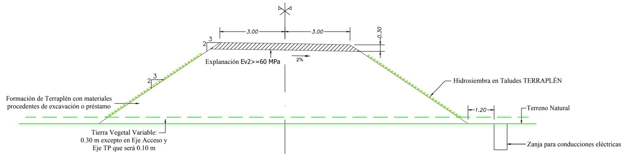
SECCIÓN TIPO VIAL EN DESMONTE
