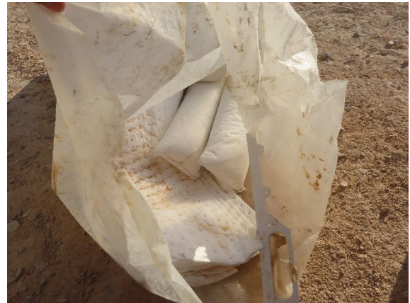
manta absorbente y barreras para contener vertidos en el suelo.
