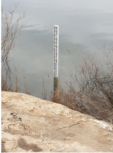
Foto 15. Regleta para el control de la altura de la lámina de agua en la salada grande.
