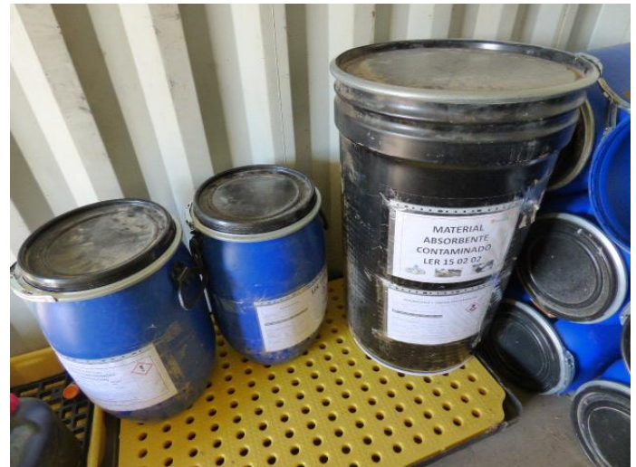
Imágenes 21 y 22: Exterior del contenedor destinado para el almacenamiento temporal de los depósitos de residuos peligrosos convenientemente identificado (fotografía de la izquierda). Depósitos homologados e identificados conforme a la normativa vigente para el almacenamiento de residuos peligrosos (fotografía a la derecha).
