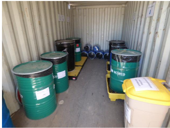
Imagen 29: Depósitos homologados e identificados conforme a la normativa vigente para el almacenamiento temporal de residuos peligrosos
