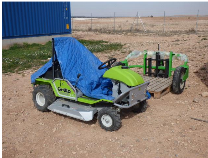
Imagen 4: Máquina utilizada para el corte de la cobertura vegetal que se desarrolla en el interior del parque fotovoltaico.
