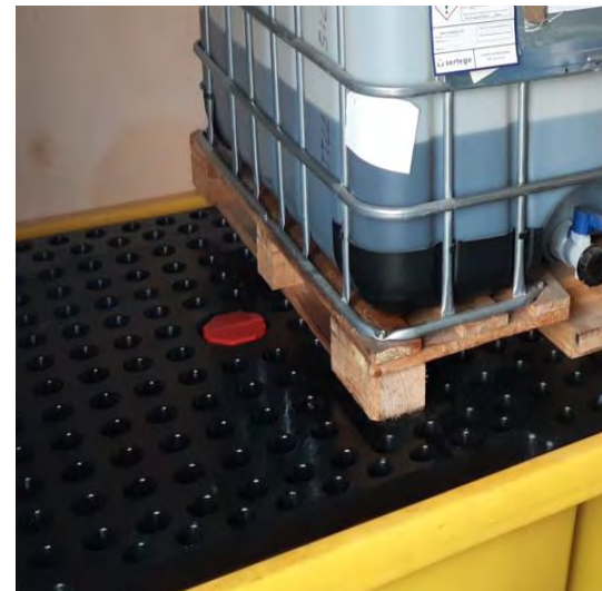
Fotografías 12 a 15: Contenedores residuos peligrosos y cubetos de retención
