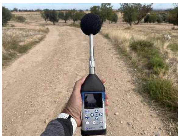
Figura 14: Sonómetro integrador modelo clase 1 SVAN 977 utilizado para la evaluación de los niveles de presión sonora en el parque eólico.
