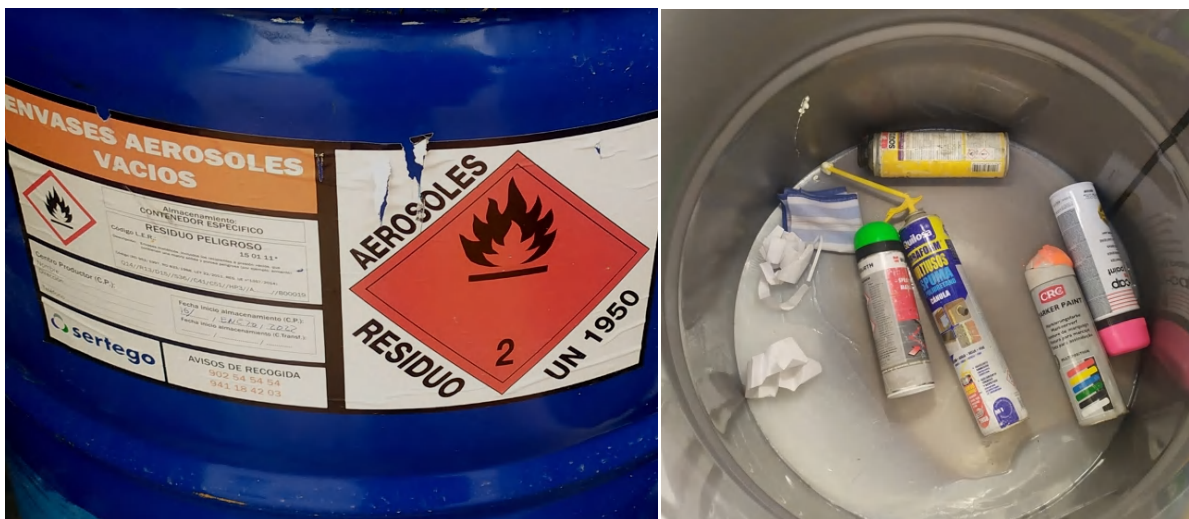
Foto 11. Bidon contenedor de envases de aerosoles vacíos correctamente etiquetado y fechado.
