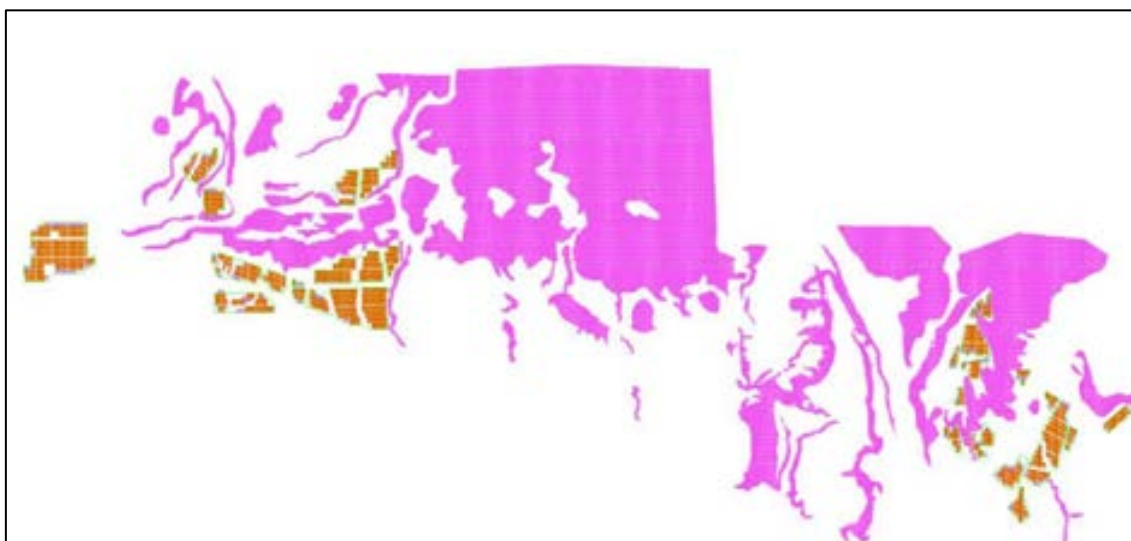
Figura 5: En color Magenta las zonas con pendientes mayores del 20% en el área próxima a los PFVs
