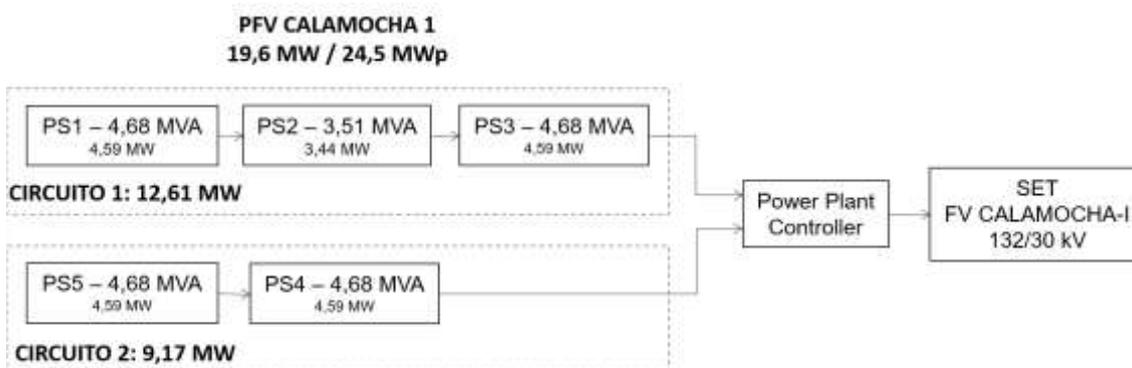
Ilustración 6: Esquema de conexión de la red de MT del PFV
