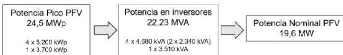
Ilustración 5: Diagrama de potencias del PFV
