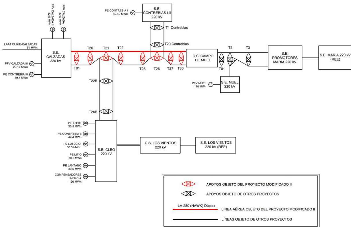
Tal y como se muestra en el esquema, la Línea Aérea de Alta Tensión 220 kV S.E. “Calzadas” – S.E. “Promotores María” - Tramo I: S.E. “Calzadas” – C.S. “Campo de Muel” discurre en configuración de doble circuito desde la S.E. “Calzadas” hasta el C.S. “Campo de Muel”.
