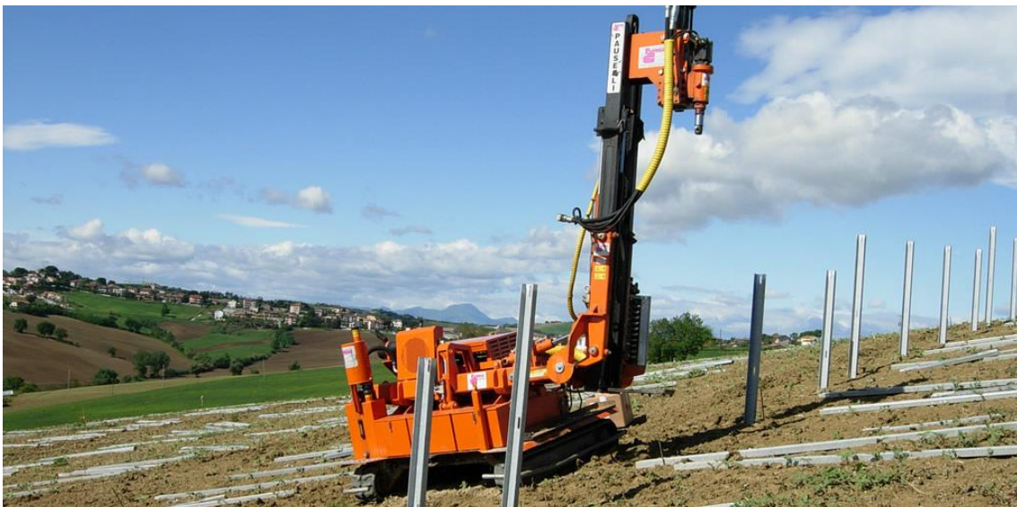
Ilustración 7: Máquina hinca postes. Fuente: Pauselli Group
