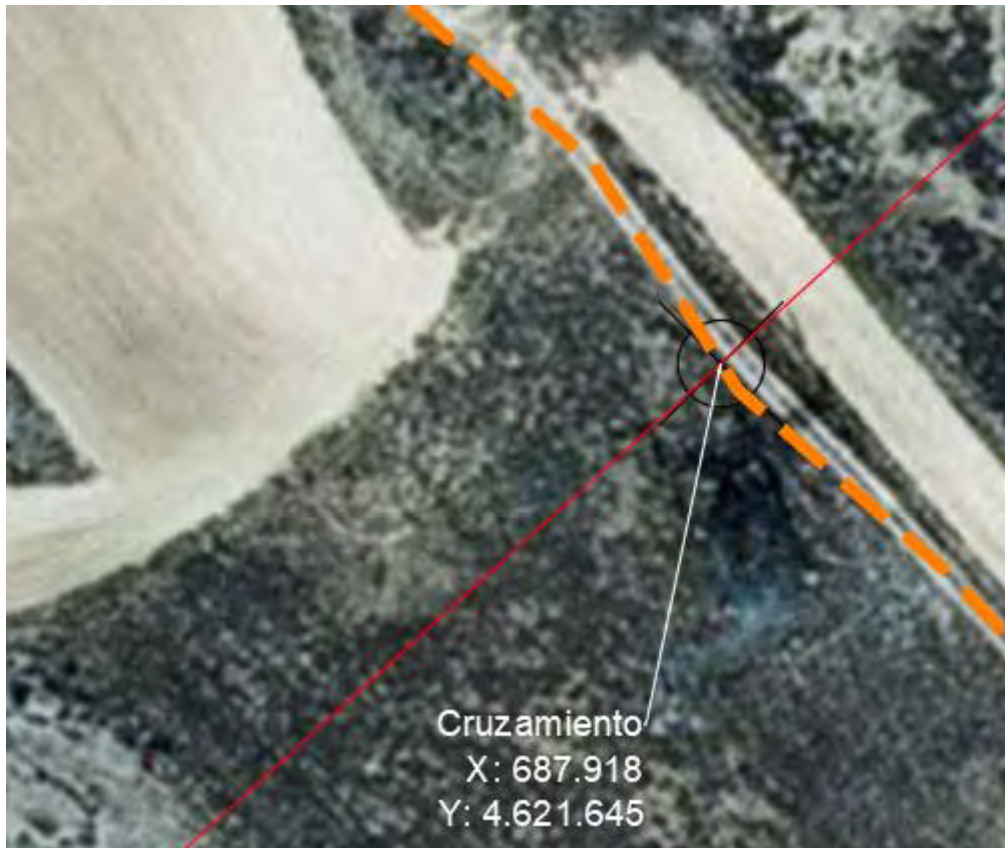
Ilustración 3: Cruzamiento zanja MT con LAATs 132 kV E-Distribución
