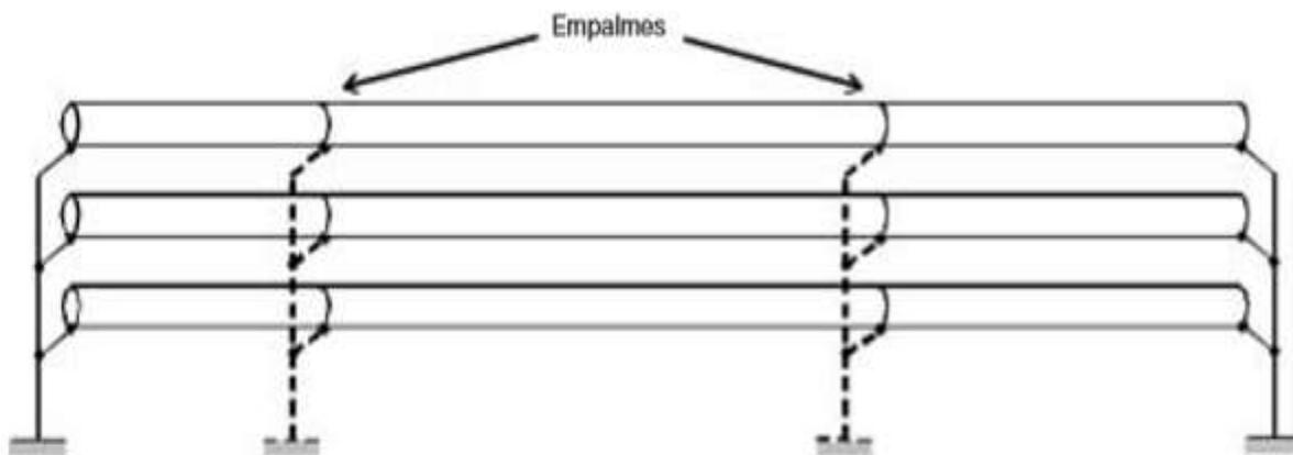
Ilustración 12: Esquema de conexión rígida a tierra
