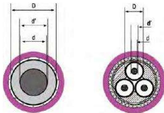
Ilustración 11: Diámetro de cuerda y semi interior del cable de la línea de evacuación
