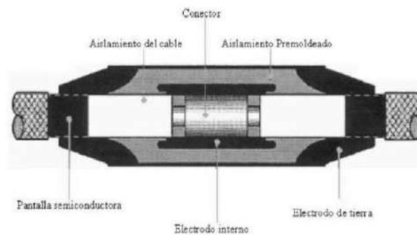
Ilustración 13: Figura de empalmes premoldeados
