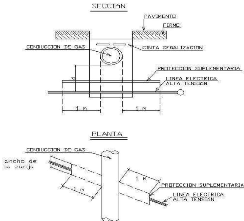
Ilustración 15: canalización de gas
