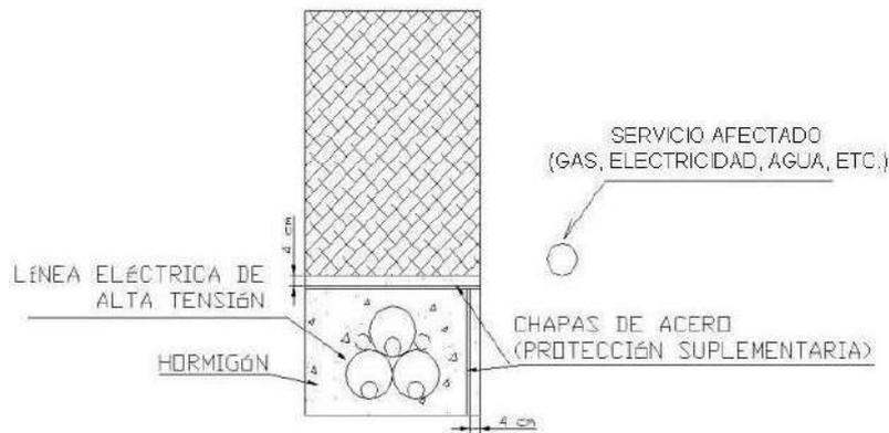
Ilustración 16: Canalización de cables de energía
