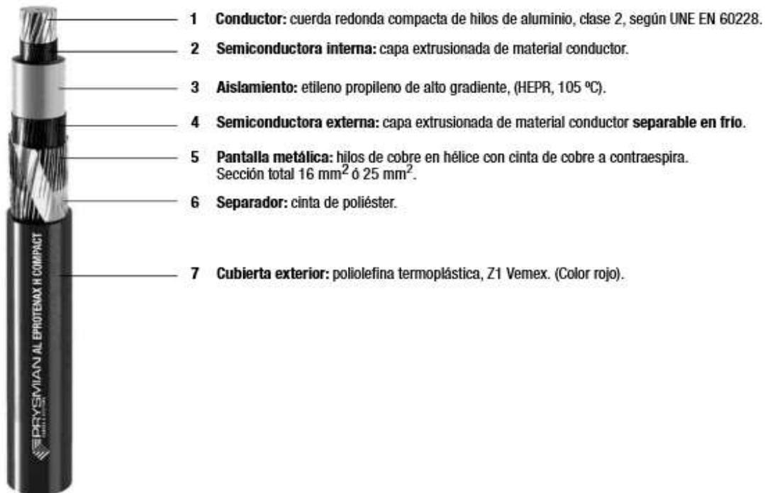
Ilustración 10: Componentes de conductor de la línea de evacuación
