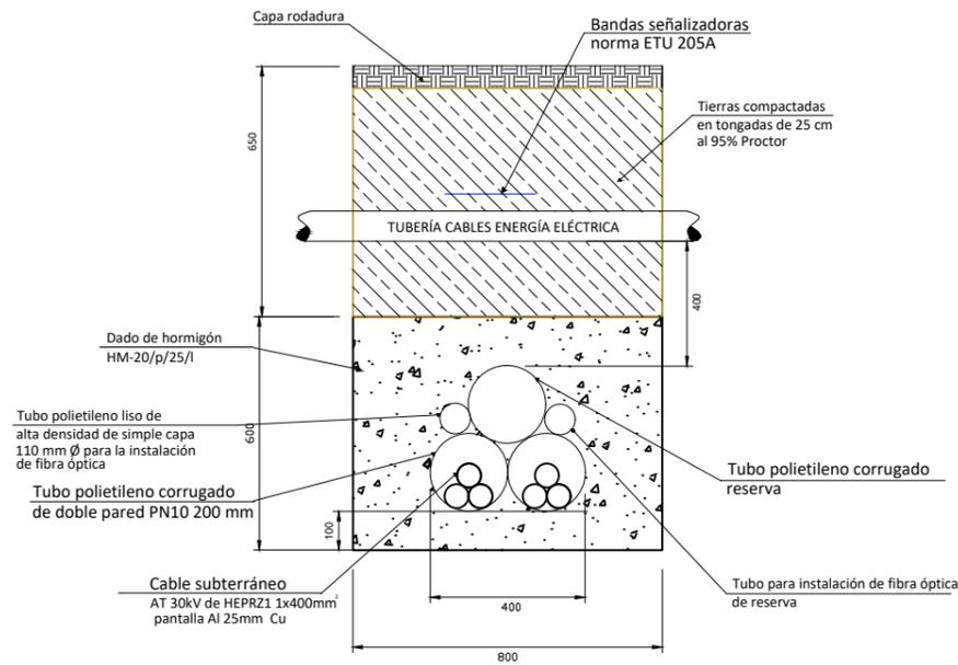
Cruzamiento con tuberías de cables de telecomunicaciones
