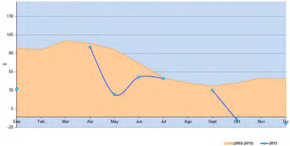
Análisis comparativo de la altura de la lámina de agua registrada en el galacho de Osera con la regleta limnimétrica: datos históricos (2010-2015) y año de estudio (2015)
