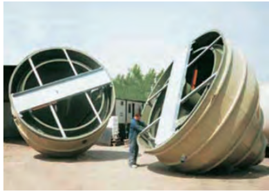
Figura 5.26. Decantadores primarios prefabricados
