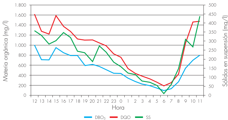
Figura 1.4. Evolución diaria de los sólidos en suspensión, DQO y DBO 5 en las aguas residuales urbanas generadas en una población de 2.000 h-e
