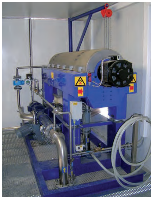
Figura 9.9. Centrífuga para la deshidratación de fangos
