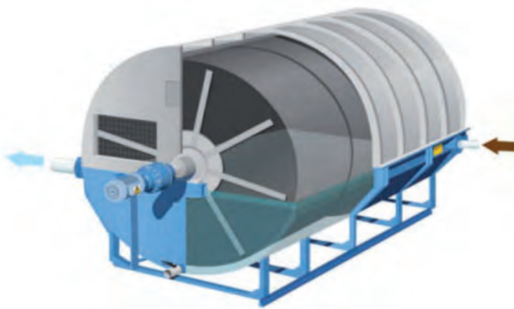
Figura 7.51. Esquema de un CBR.
