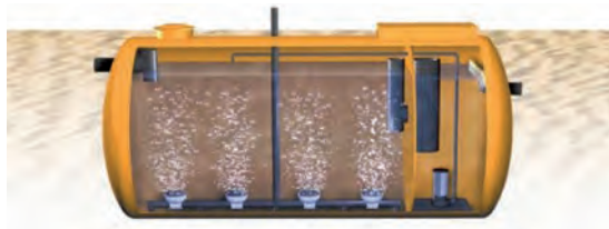
Figura 7.12. Plantas prefabricadas enterradas con decantador integrado
