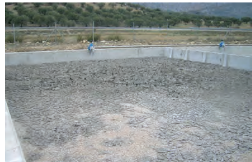
Figura 9.5. Aspecto de los fangos deshidratados en Eras de Secado
