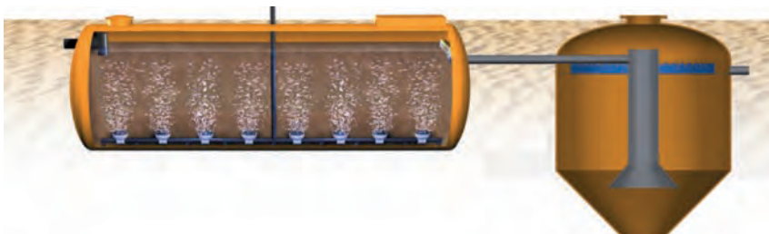
Figura 7.13. Plantas prefabricadas enterradas con decantador separado
