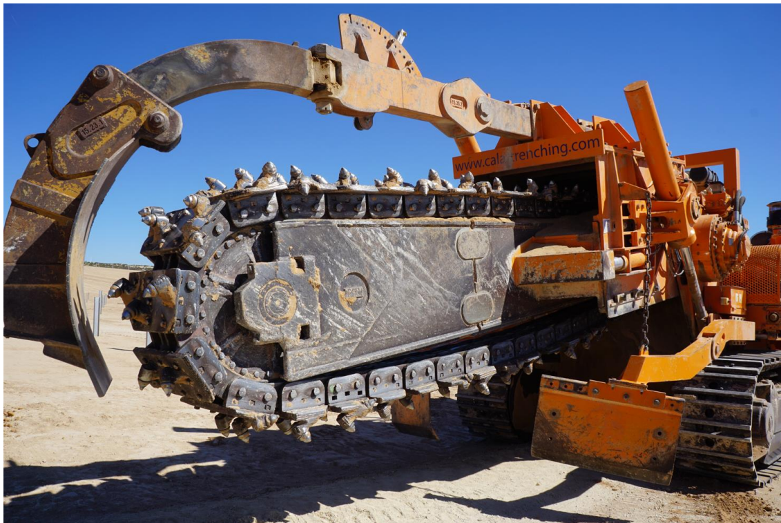
Figura 8 Maquinaria pesada para excavación de zanjas
