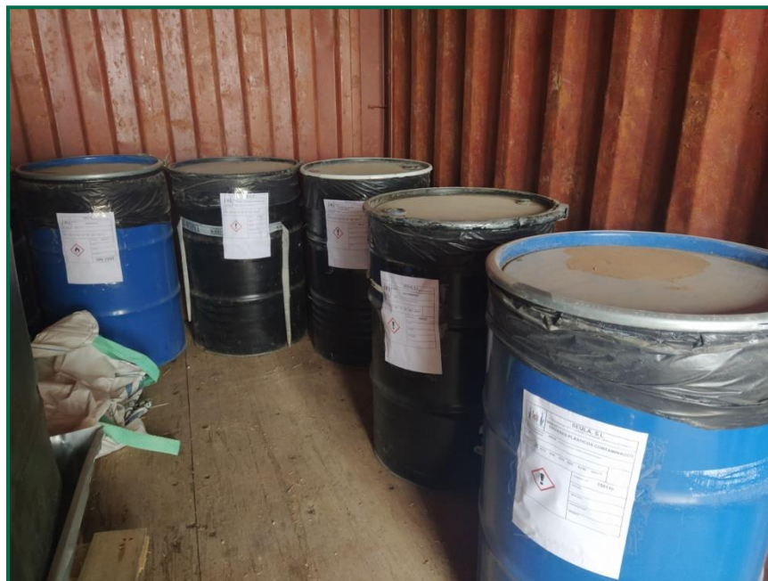
Fotografía 7. Bidones para residuos peligrosos.
