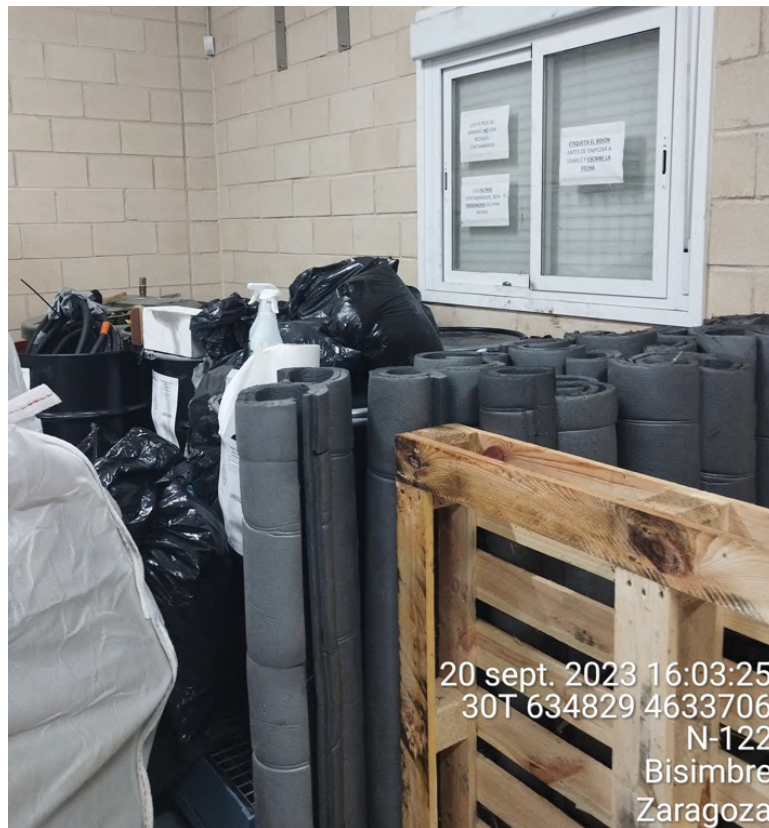
Figura 40: Interior del almacén de residuos de la SET “Valcardera”, con los diferentes residuos peligrosos clasificados con su código LER correspondiente, aislados de la intemperie y sobre una tarima aislante para evitar posibles filtraciones al suelo.
