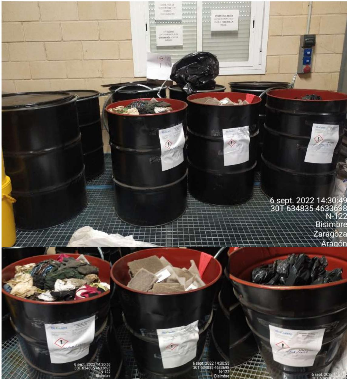
Figura 36: Interior del almacén de residuos de la SET “Valcardera”, con los diferentes residuos peligrosos clasificados con su código LER correspondiente, aislados de la intemperie y sobre una tarima aislante para evitar posibles filtraciones al suelo.
