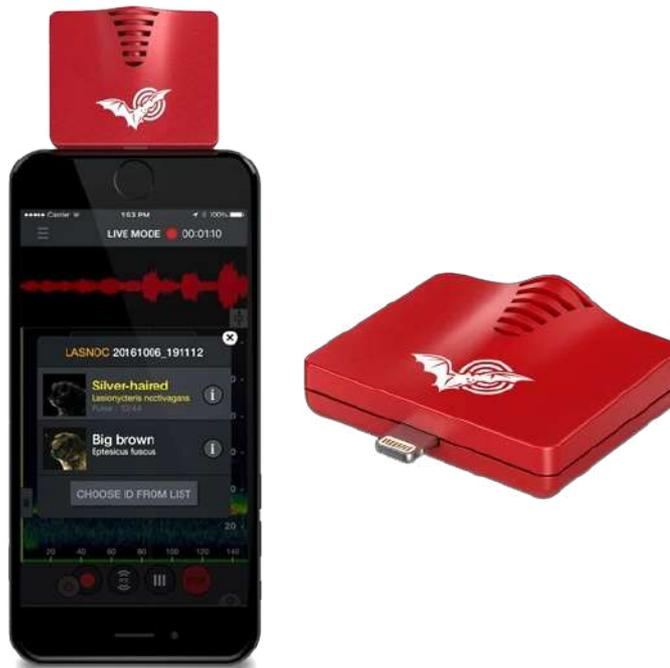
Figura 22: Detalle del dispositivo Echo Meter Touch insertado en un smartphone con la aplicación de utilización específica. Fuente: <https://www.wildlifeacoustics.com>.
