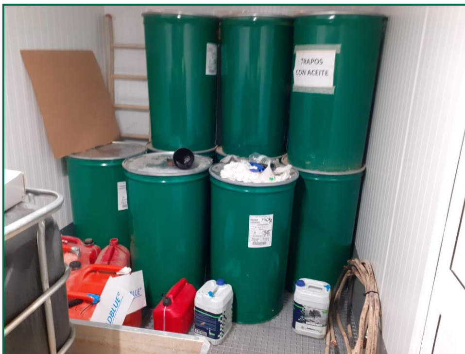
Fotografía 4. Bidones para residuos peligrosos.
