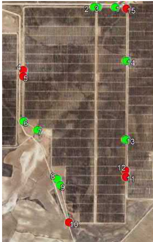
Figura 1: Mapa con la ubicación de las torres de vigilancia con cableado expuesto junto con los códigos adjudicados para su identificación (georreferenciado por el técnico de medio ambiente). Torretas con cableado expuesto (círculos rojos), torretas con cableado no expuesto (círculos verdes).
