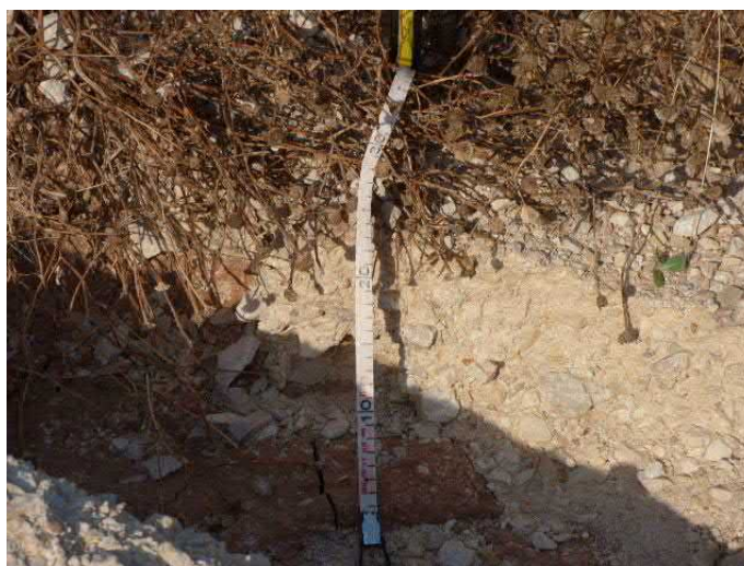
Imágenes 1 y 2 : Signo de erosión dentro del vial interno del parque fotovoltaico Híjar I.
