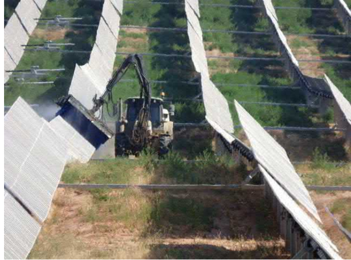
Imágenes 5 y 6: Extensión utilizada para la limpieza de paneles (izquierda). Tractor con la extensión adjunta, realizando la limpieza de paneles (derecha).
