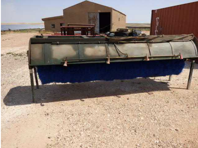
Imágenes 5 y 6: Extensión utilizada para la limpieza de paneles (izquierda). Tractor con la extensión adjunta, realizando la limpieza de paneles (derecha).
