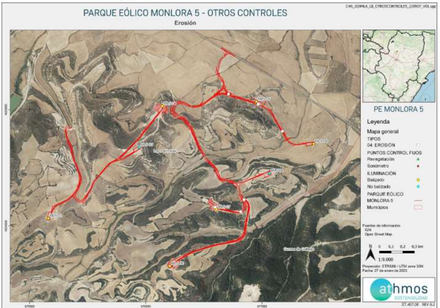
Fig. 1 Puntos detectados con degradación erosiva en el parque eólico Monlora 5 del Clúster Monlora. Fuente: Elaboración propia.
