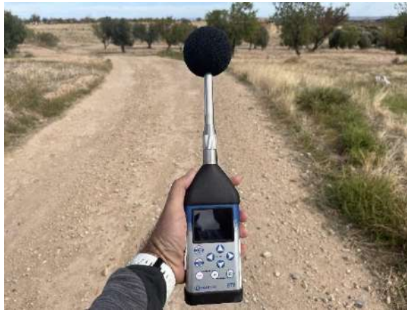
Figura 15: Sonómetro integrador modelo clase 1 SVAN 977 utilizado para la evaluación de los niveles de presión sonora en el parque eólico.
