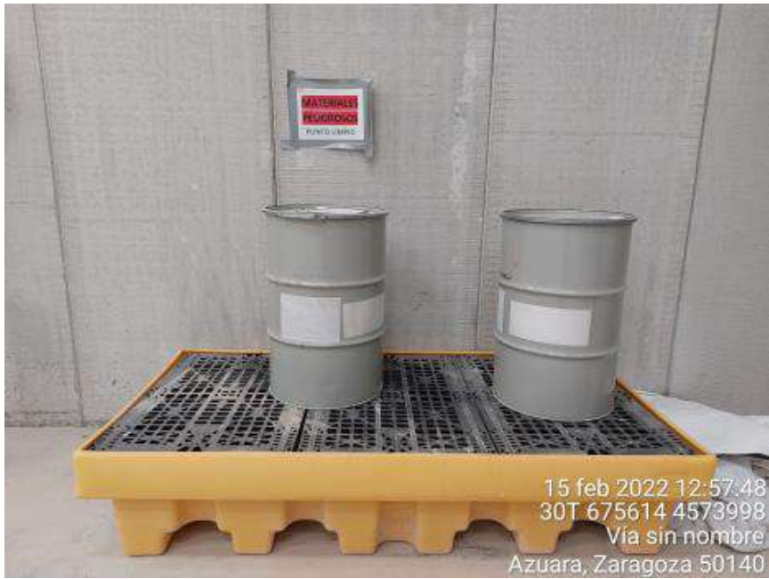
Imagen 5. Punto limpio. Zona para residuos peligrosos
