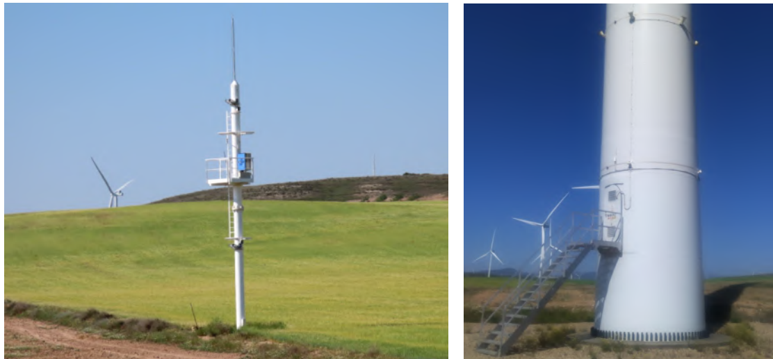
Figura 7: Fotografías del Sistema “3D Observer” ubicado junto al aerogenerador LLo7 (izquierda) y del Sistema “DTBird” instalado en el aerogenerador LLo8 (derecha).
