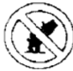
PROHIBIDO APAGAR CON AGUA
