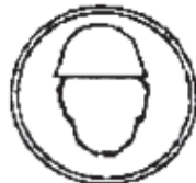
USO OBLIGATORIO DE CASCO PROTECCION
