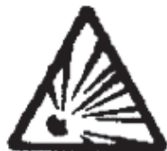
RIESGO DE EXPLOSION MATERIAL EXPLOSIVO
