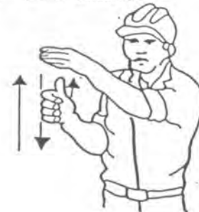
4 Levantar el aguilón o pluma lentamente
