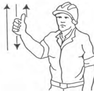
4 Levantar el aguilón o pluma lentamente
