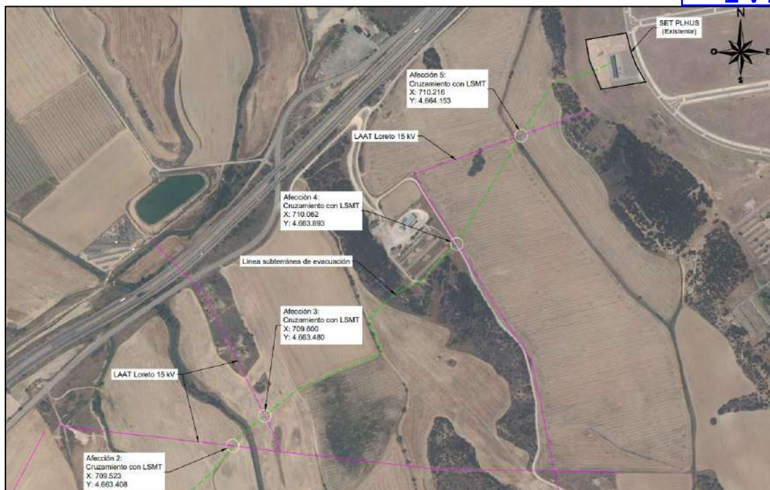
Ilustración 4: Afecciones PFV La Hoya a e-Distribución Redes Digitales – LAMT Loreto 15 kV
