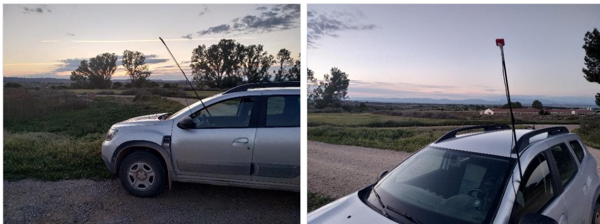
Fotografía 3. Colocación del detector sobre pértiga elevada durante transecto de escucha.
